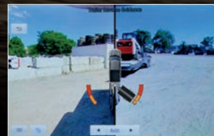
NUEVAS GUÍAS DE REVERSA PARA TRÁILER Esta característica disponible le proporciona visualizaciones de la cámara y gráficas para ayudarle a retroceder y estacionar su remolque.
